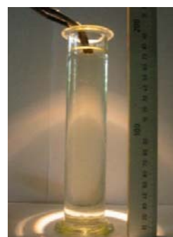
Abb. 6: Analogie-Experiment „Glaskugelfall in Öl“.
