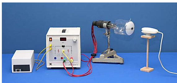
Abb. 4: Ansicht des RCL Elektronenbeugung (von links nach rechts: Mikrocontroller-Interface, hier ohne Kabel zum Server und zum Steckernetzteil, steuerbares Netzgerät Leybold Nr. 521 70, Elektronenbeugungsröhre Leybold Nr. 555 626, Webcam).
